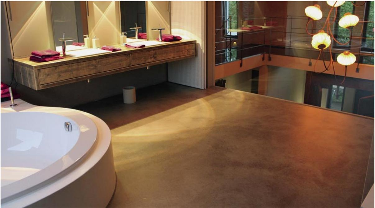
*Bild 4: Auch für Nassbereiche sind Zementestrichböden bestens geeignet, da sie feuchteunempfindlich sind.*
